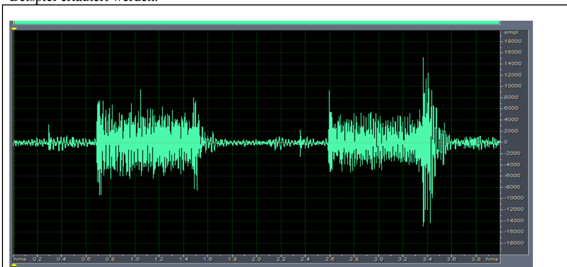
Abbildung 5: Geräusch beim motorisch angetrieben Öffnen und Schließen eines Flachbildschirms
